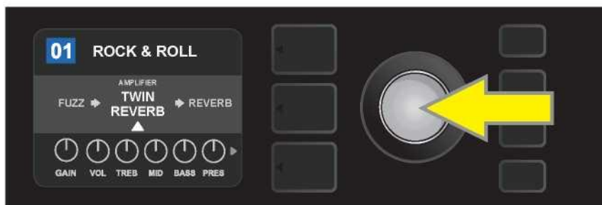
Zvýrazněný model zesilovače, který má být nahrazen jiným modelem zesilovače, v ÚROVNI SIGNÁLOVÉ CESTY (je označen bílou šipkou pod a popiskem „AMPLIFIER“ (zesilovač) nad názvem zesilovače). Nejprve stiskněte ENKODÉR, tím vstoupíte do nabídky modelů zesilovačů.
