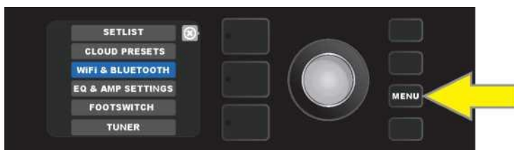
Pomocí ENKODÉRU se posuňte na možnost „WIFI & BLUETOOTH“, poté stiskněte ENKODÉR na „BLUETOOTH“.
