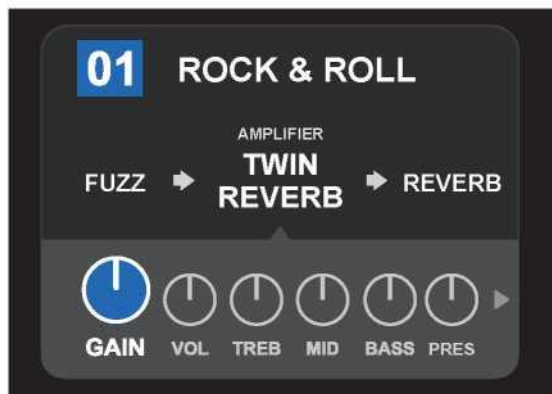
Detailní pohled na ÚROVNĚ OVLADAČŮ, u dané předvolby je vybrán ovladač gain u modelu zesilovače použitého v předvolbě.
