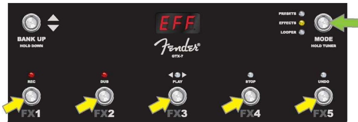
Příklad režimu efektů (EFFECTS) znázorňující předvolbu se dvěma efekty, přiřazenými FUNKČNÍM tlačítkům FX1 a FX2. Rozsvícená červená LED kontrolka FUNKCE nad tlačítky FX1 a FX2 indikuje, že oba efekty jsou zapnuté. Každý z těchto dvou efektů lze vypnout sešlápnutím příslušného FUNKČNÍHO TLAČÍTKA.
