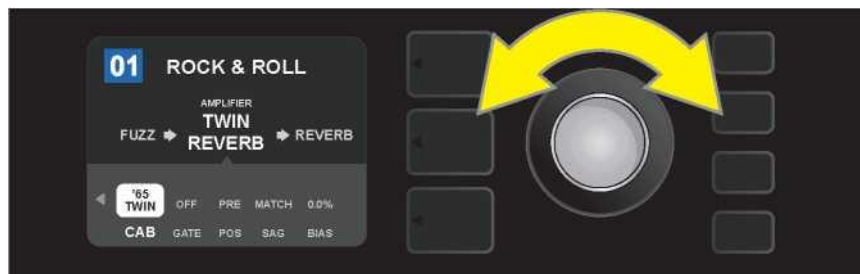
Pomocí ENKODÉRU se můžete posouvat mezi jednotlivými parametry a ovládacími knoflíky v ÚROVNI OVLADAČŮ, volit je a upravovat jejich nastavení.
